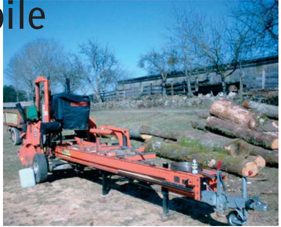
▲ Scie mobile installée sur terrain plat et facile d'accès.
